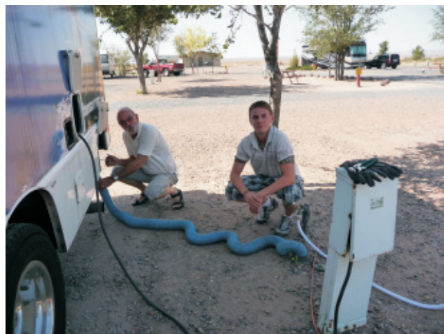
Auf dem Campground ankommen: Sofort wird Strom, Frisch- und Abwasser angeschlossen
